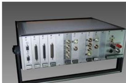
Аппаратура контроля нейтронного потока для АЭС, исследовательских реакторов и критических стенов
