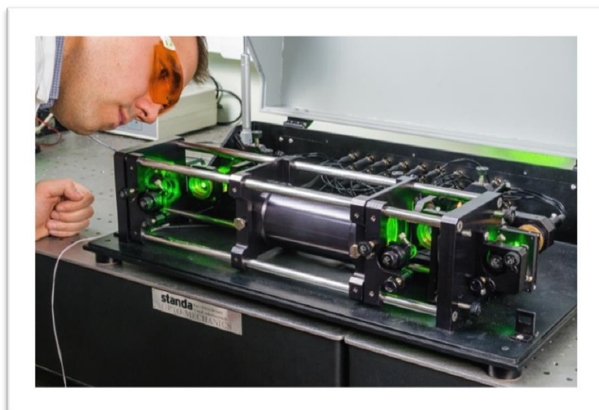
Настройка квадратурного дифференциального неравноплечного интерферометра для измерения скорости
