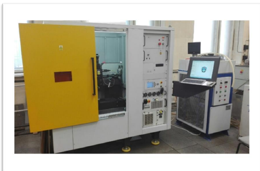
Установка для микрообработки на базе твердотельного лазера с диодной накачкой
